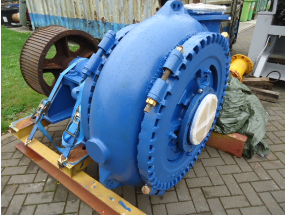
(抽砂幫浦示意圖，鋼體左下方突起之蓋狀物為檢視窗) 泥砂由白色方向吸入，旋轉 90 度後由照片右後方排出
